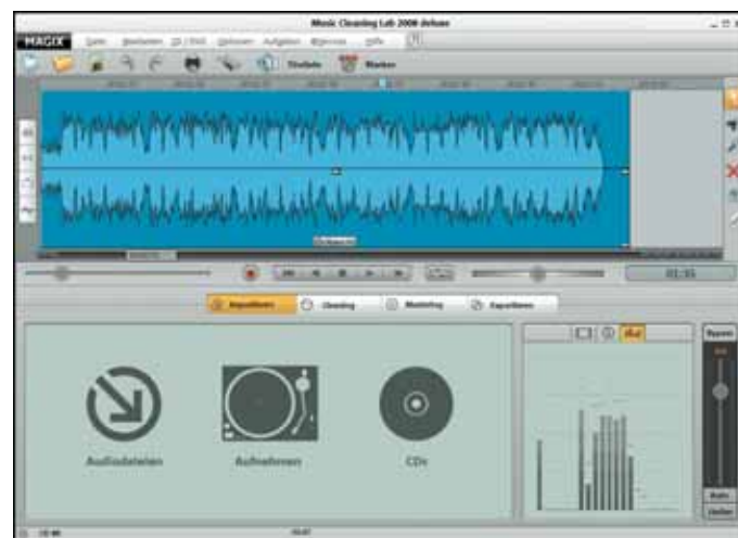
In diesem Menü wählt man zwischen Dateimport, Plattenaufnahme und dem Einlesen einer CD. Rechts der Pegelregler mit Lautstärkebegrenzer (Limiter) zum Vermeiden von übersteuerten Aufnahmen.
