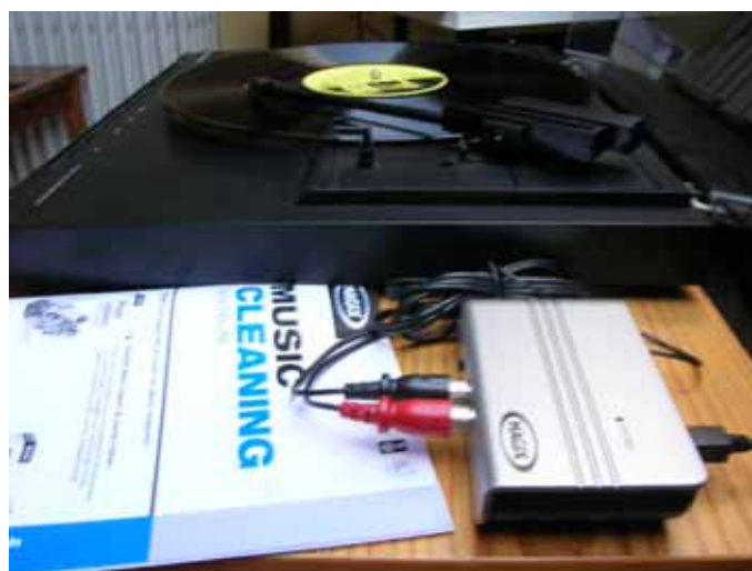
Der Phonovorverstärker während einer Aufnahme: links die beiden Cinchkabel vom Plattenspieler, rechts das Massekabel und die USB-Verbindung zum Notebook.
